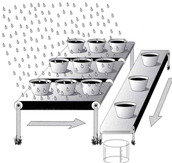
Figur 29. CCD'ens virkemåde illustreret med spande.
